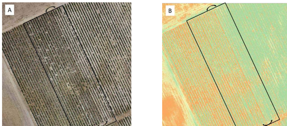
Fig. 14. Identificação da zona de transição (setas a preto) de duas regiões de elevada variabilidade do solo na vinha em imagem RGB (A) e com valores de VARI de toda a parcela (B). Retângulo preto representa a zona em estudo.
