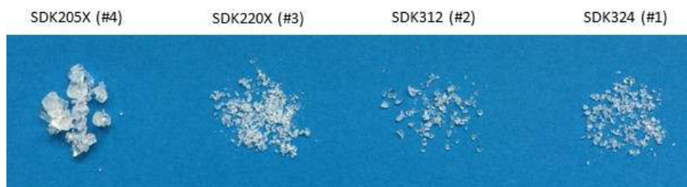
Fig. 1. Imagem das quatro granulometrias de SAPs desidratados. Código da granulometria: #4: grande; #3: fina; #2: média; #1: muito fina (SOCO series).
