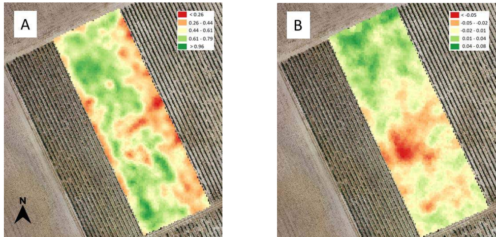
Fig. 13. Kriging para análise da variabilidade espacial da parcela em estudo relativamente à (A) área da copa em m 2 /m e (B) VARI (adimensional). Valores obtidos de 11 pixéis exclusivamente referentes à linha (videiras).
